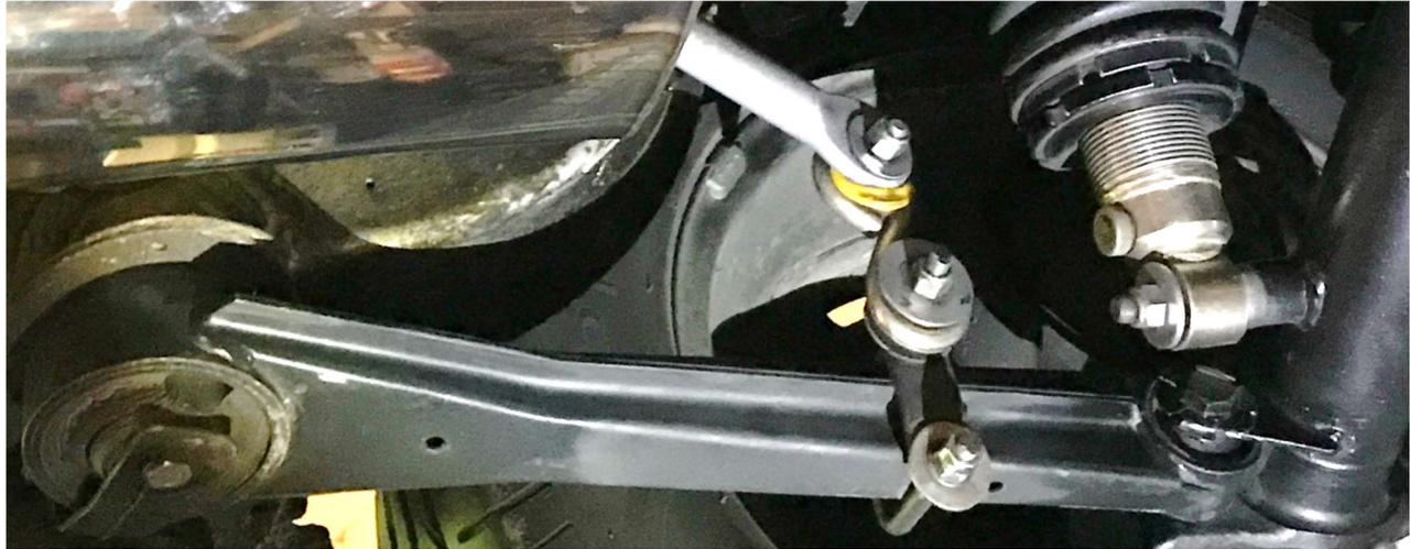
Der neue Trailing Arm **C41831** mit verstellbarer Zugstange (Eigenbau) sieht doch professioneller aus ☺
