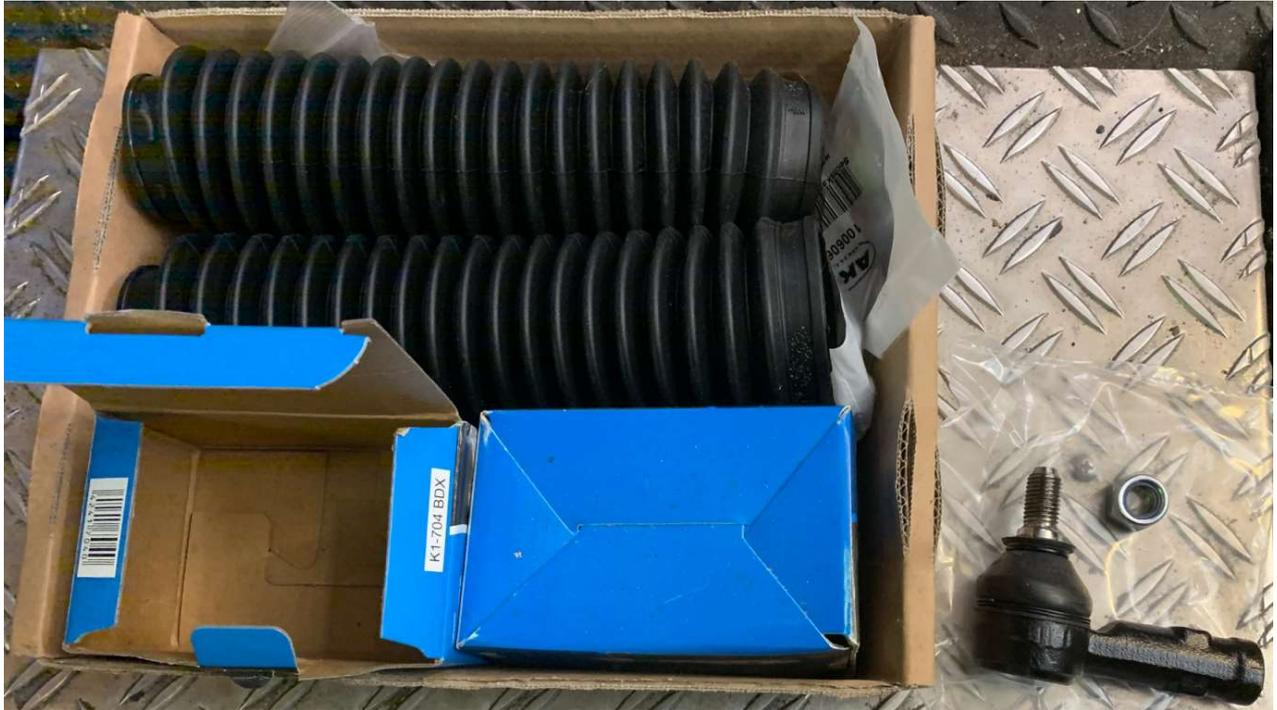
**Es ist zwingend notwendig, die Positionen der Spurstangenköpfe genau zu markieren und nach dem Zusammenbau den Spurwinkel zu kontrollieren !!!**
