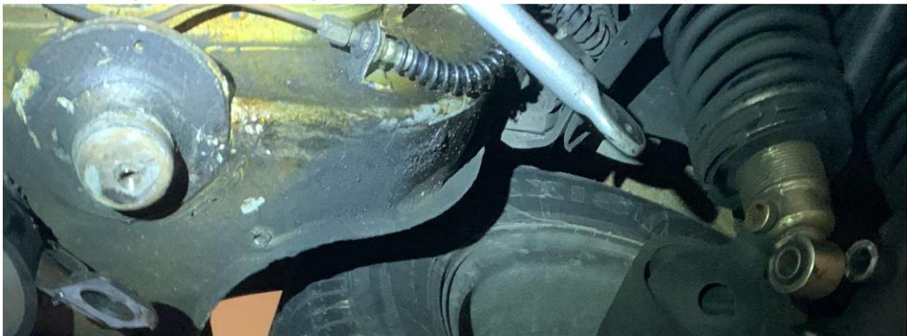
Hier mit dem neuen Träger C41831 und Zugstange zum Stabilisator
