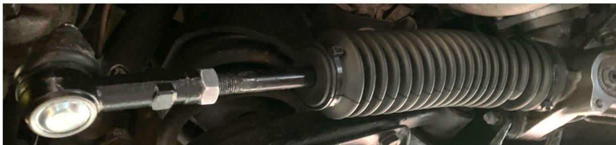
**Es ist zwingend notwendig, die Positionen der Spurstangenköpfe genau zu markieren und nach dem Zusammenbau den Spurst Winkel zu kontrollieren !!! Spurstangenköpfe müssen Hersteller-abhängig nicht zwingend gleich lang sein !!! Spureinstellen sollte ein Fachbetrieb vornehmen.**
