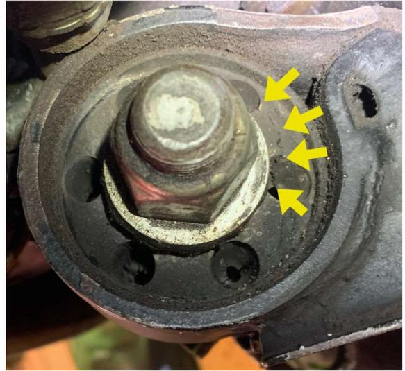
Ausbau der Vorderachslager **C30314**. Hierzu muss der Hilfsrahmen der Vorderachse unterstützt werden, erst dann kann die Halteschraube des Lagerhalters gelockert werden und das Lager mit Buchse **C30371** herausgezogen werden. **Auf der Vorderachse lastet der Motor !**
